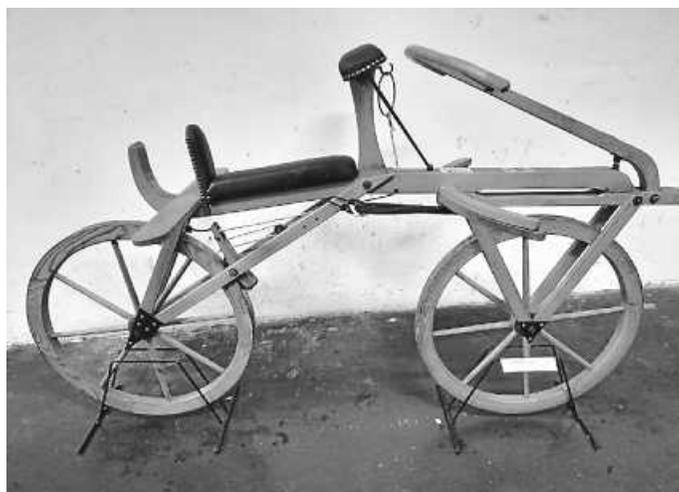
Nachbau der Drais-Laufmaschine 1817.
